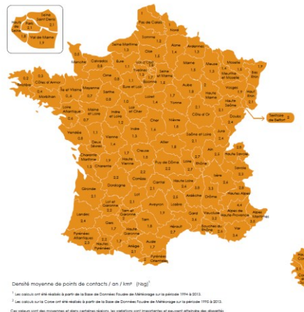
Figure 22 : Carte de la densité de foudroiement de la France issue de la norme NFC 17-102 (05-2015)
